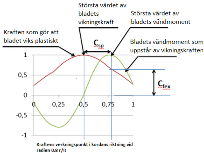
Figur 6-5. Schematisk figur som visar bladhaveribelastningen och relaterat vridmoment för spindelns när kraften verkar på en annan plats på kordan vid radien 0,8R.
