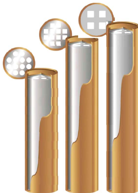
■ Kuva 4. Loppusijoituskapselit eri polttoainetyypeille; vasemmalla Loviisa 1-2 (VVER 440) kapselityyppi, Olkiluoto 1-2 (BWR) keskellä ja Olkiluoto 3 (EPR, OL3) oikealla.
