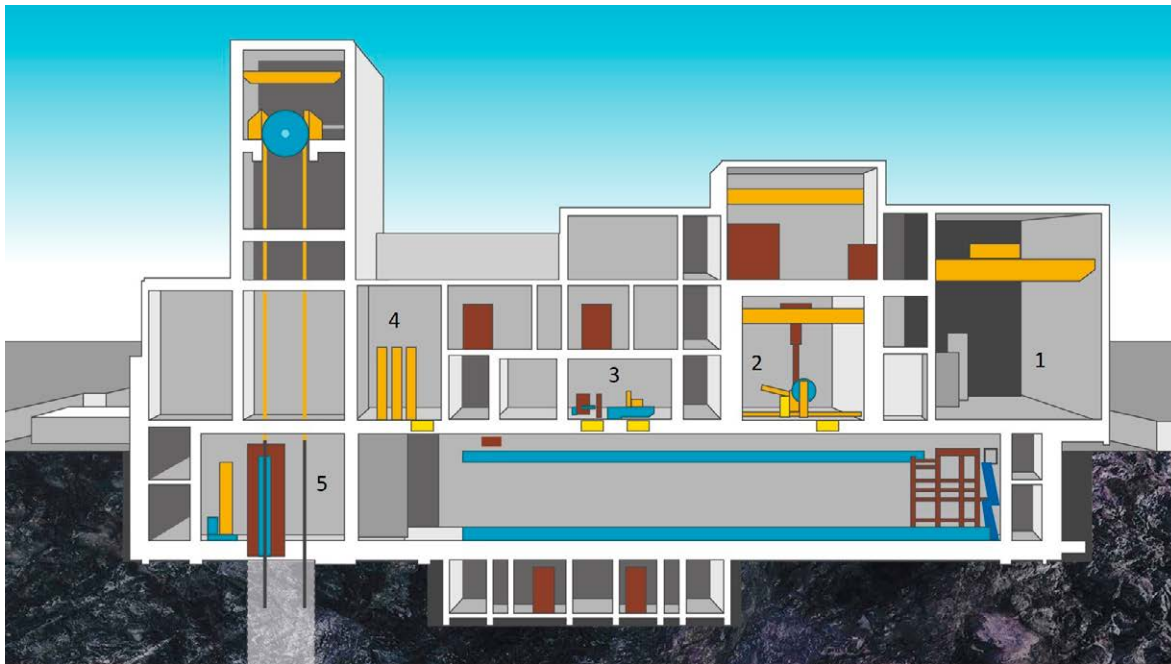
■ Kuva 4. Pituussuuntainen leikkauskuva kapselointilaitoksesta. Oikealla on kuljetus- ja siirtosäiliöiden vastaanotto- ja varastotila (1). Siitä vasemmalle päin sijoittuvat mm. polttoaineen käsittelykammio (2), kuparikannen hitsauslaite sekä koneistus- ja tarkastusasema (3), tyhjien kapselien vastaanotto- ja varastointitila (4) ja kapselihissi (5).
