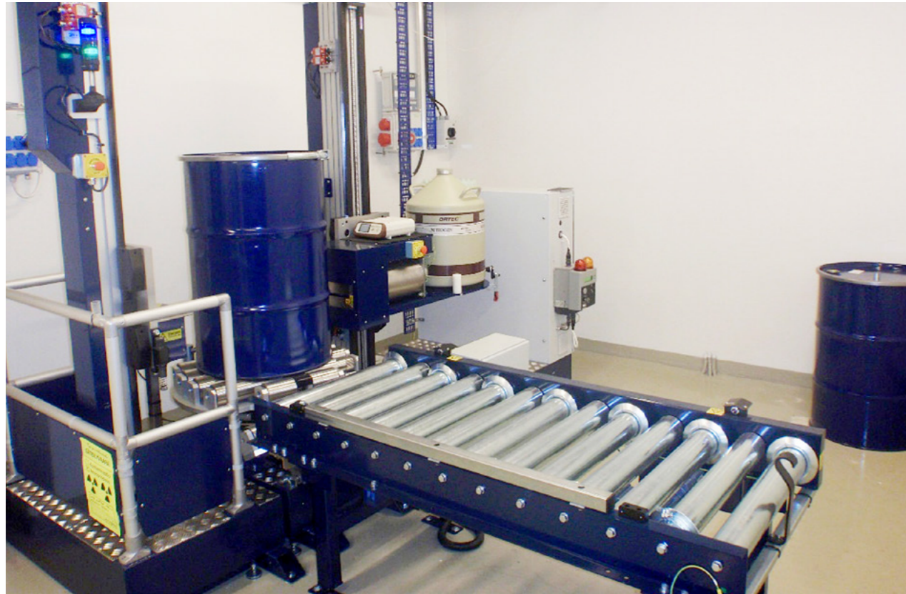
Kuva 9-3. Gammaspetrometrialaitteisto, jolla mitataan huoltojätetyynyrien radioaktiivisuus.
