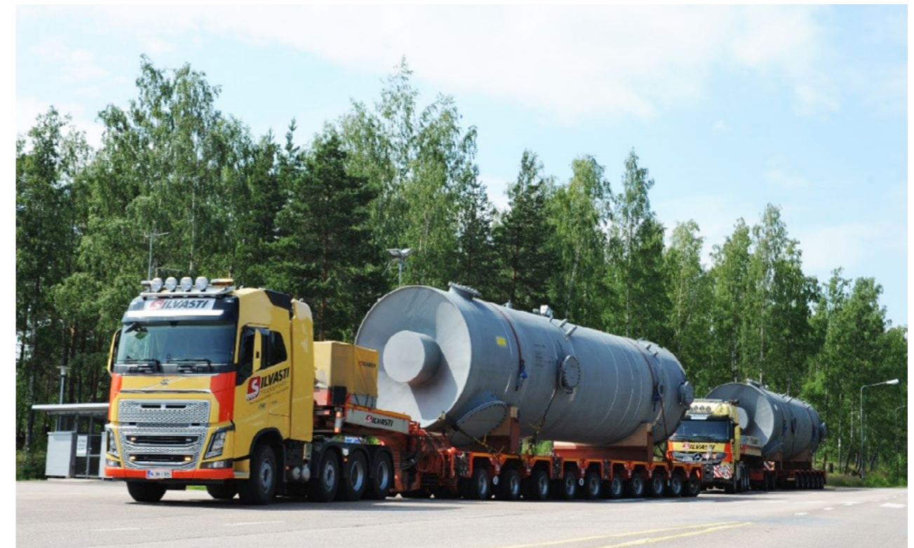
Kuva 5-14. Uusia välitulistimia saapuu Loviisan voimalaitokselle vuonna 2018.
