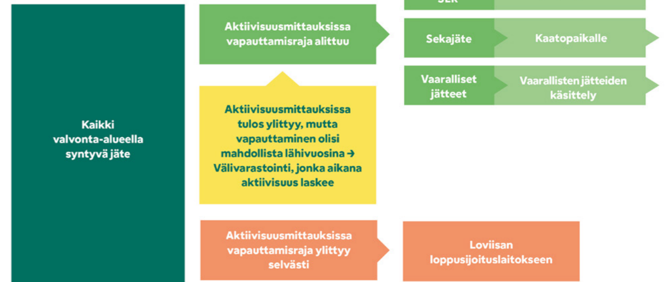
Kuva 9-4. Valvonta-alueella syntyneen ydinlaitosjätteen käsittelyn ja loppusijoituksen yleisperiaatteet.
