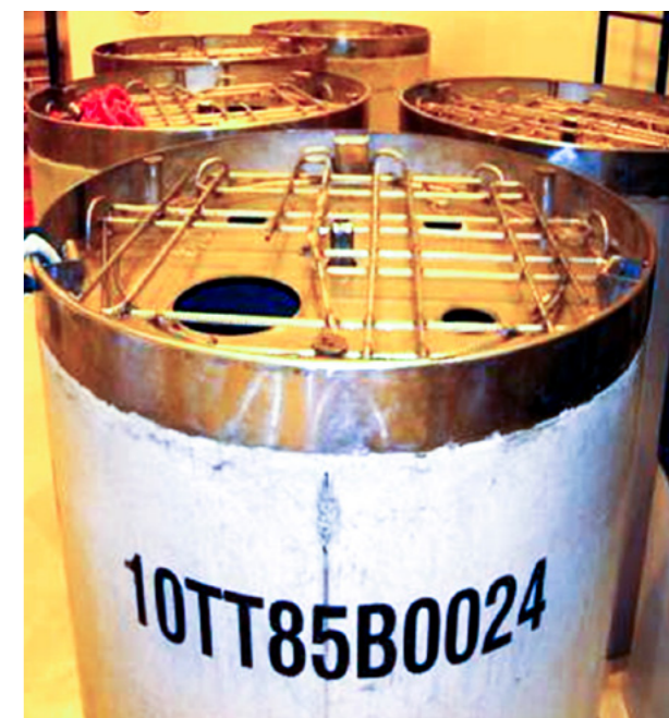
Kuva 5-2. Betoniastia, johon nestemäistä jätettä kiinteät jätteen.
