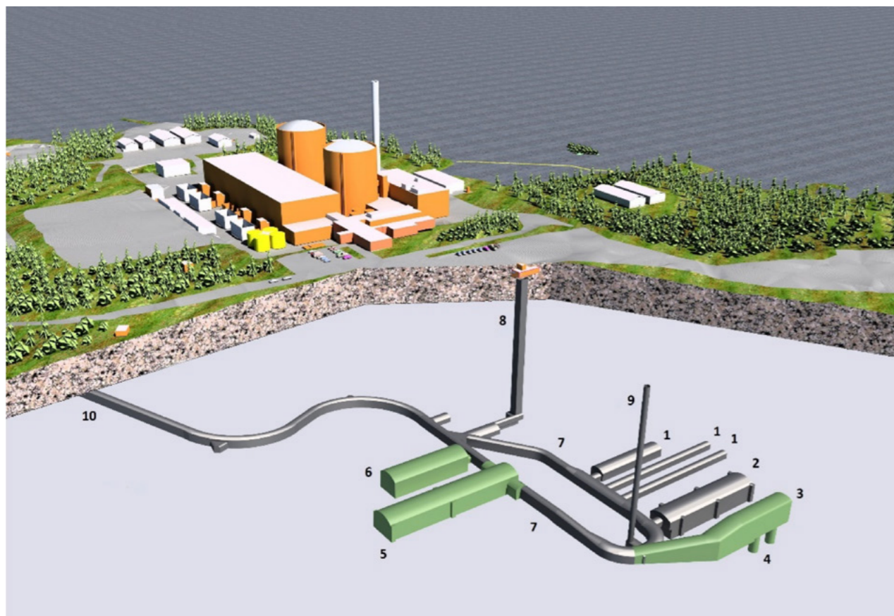
Kuva 5-1. Loviisan matala- ja keskiaktiivisen jätteen loppusijoituslaitos. Nykyiset tilat on merkitty harmaalla ja suunnitellut, tulevaisuudessa louhittavat tilat vihreällä. Numeroiden selitykset: 1 - tilat huoltojätteille (3 kpl), 2 - kiinteät jätteen tila, 3 - suurten komponenttien tila, 4 - reaktoripainesäiliöiden siilot, 5 - purkujättila 1, 6 - purkujättila 2, 7 - yhdystunneli, 8 - henkilökoulu, 9 - ilmanvaihtokoulu, 10 - ajotunneli.
