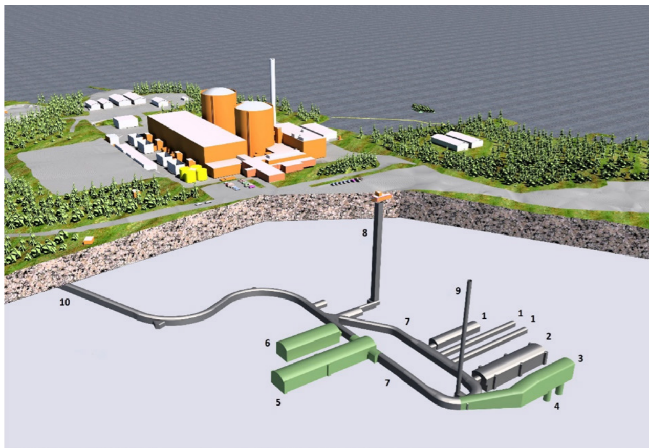
Bild 5-1. Slutförvarsanläggning för låg- och medelaktivt avfall i Lovisa. De nuvarande utrymmena anges med grått och de planerade framtida utrymmena med grönt. Sifferförklaringar: 1 – hallar för serviceavfall (3 st.), 2 – hall för solidifierat avfall, 3 – hall för stora komponenter, 4 – silor för reaktortryckkärl, 5 – hall för rivningsavfall 1, 6 – hall för rivningsavfall 2, 7 – förbindelsetunnel, 8 – personalschakt, 9 – ventilationsschakt, 10 – körtunnel.
