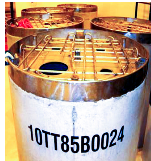
Bild 5-2. Betongkärll i vilket vätskeformigt avfall solidifieras.
