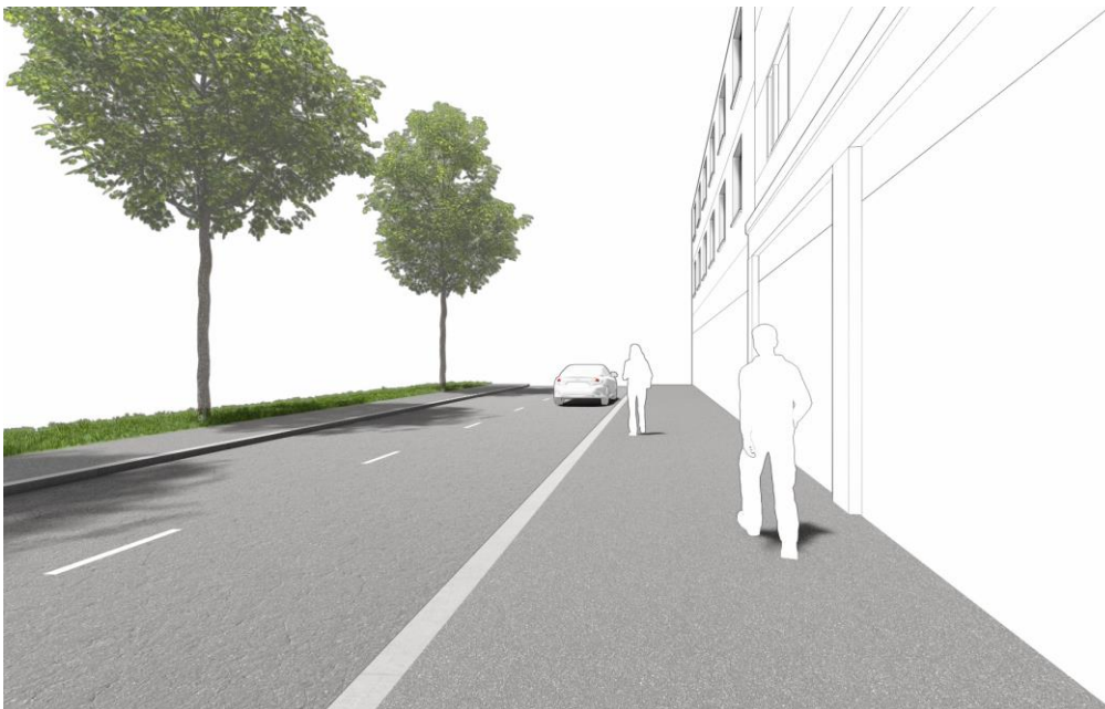
Kuva 27 Jalkakäytävä erotetaan rakenteellisesti ajoradasta.
