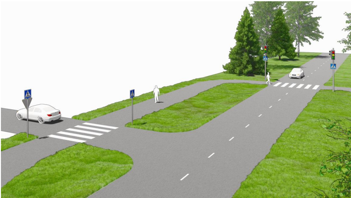
Kuva 46 Keskikorokkeeton suojatie voidaan valo-ohjata enintään 50 km/h tiellä vähintään 20 m etäisyydellä risteyksestä, jos risteyksen suunnasta on enintään yksi ajokaista ja sivusuunnat ovat vähäliikenteisiä ja väistämisvelvollisia.
