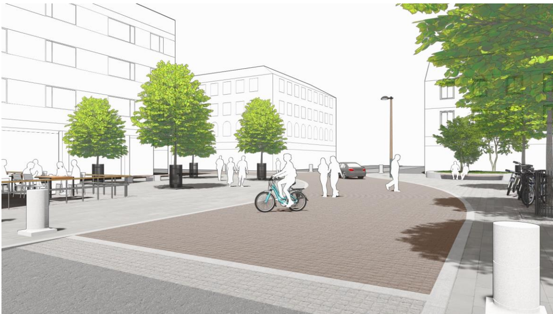
Kuva 60 Yhteisen tilan (shared space) periaatteella toteutetussa katutilassa liikennettä voidaan jäsentää pollareilla, päällysteillä ja kalusteilla.
