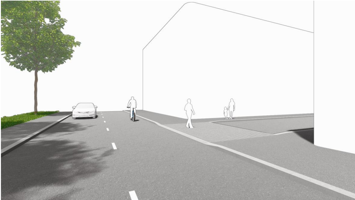
Kuva 51 Jalankulkija ylittää risteävän kadun ylijatkettua jalkakäytävää pitkin suojatien sijaan. Näkövammaisen turvallisuutta voidaan parantaa varustamalla ylijatketun jalkakäytävän osa esim. noppakivivyöhykkeellä.
