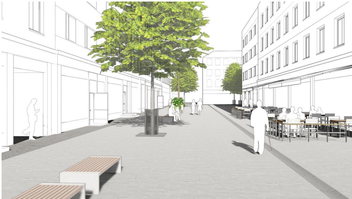
Kuva 77 Erilaiset materiaalit ohjaavat näkövammaista. Esimerkiksi hulevesikourut voivat toimia ohjaavana elementtinä, kunhan ne eivät aiheuta kompastumisvaaraa, ja valkoinen keppi ei kulkeudu kaivon uraan.
