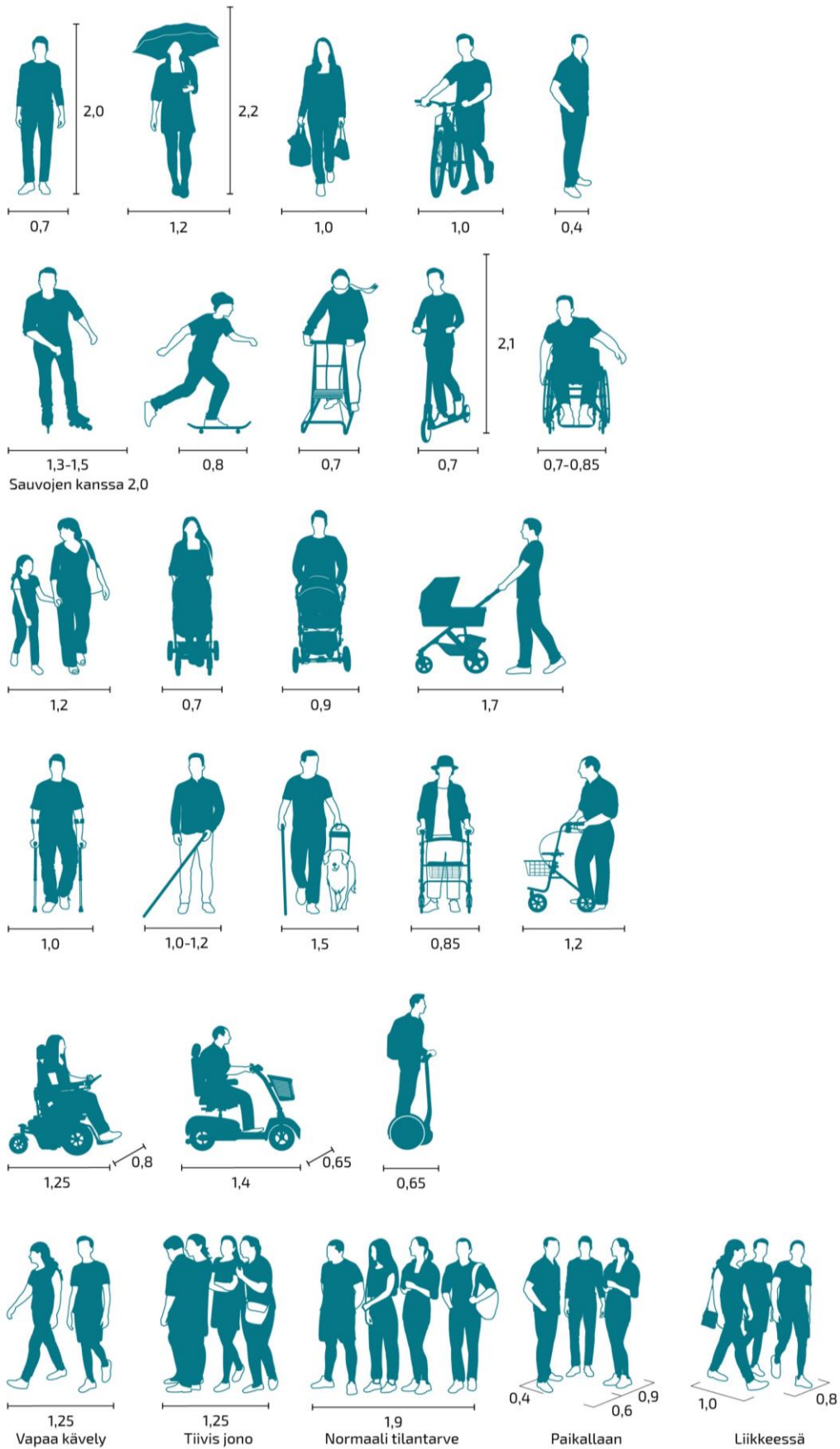
Kuva 4 Jalankulkijoiden tilantarpeita. Jalankulkuväylien mitoituksesta on kerrottu kohdassa 5.1.
