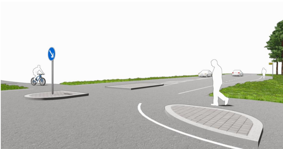
Kuva 49 Ajoradan rakenteellinen ylityspaikka keskisaarekkeella toteutettuna.
