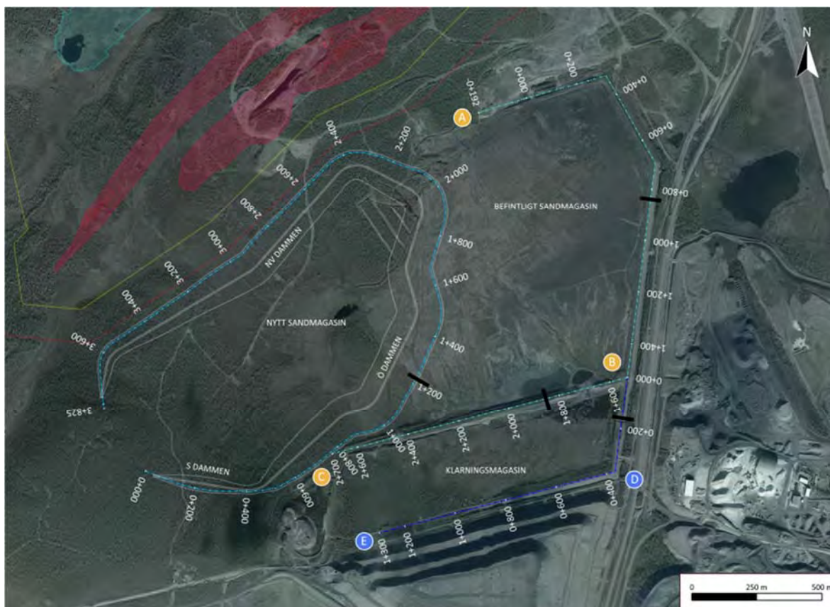
Figur 8. Översiktsplan som visar nytt sandmagasin, befintligt sand- och klarningsmagasin, gruvans dagbrott (rödskuggat område) samt de sektioner (svarta streck) för vilka stabilitetsberäkningar har utförts. Dammsträckor visualiseras med bokstäverna A-E.
