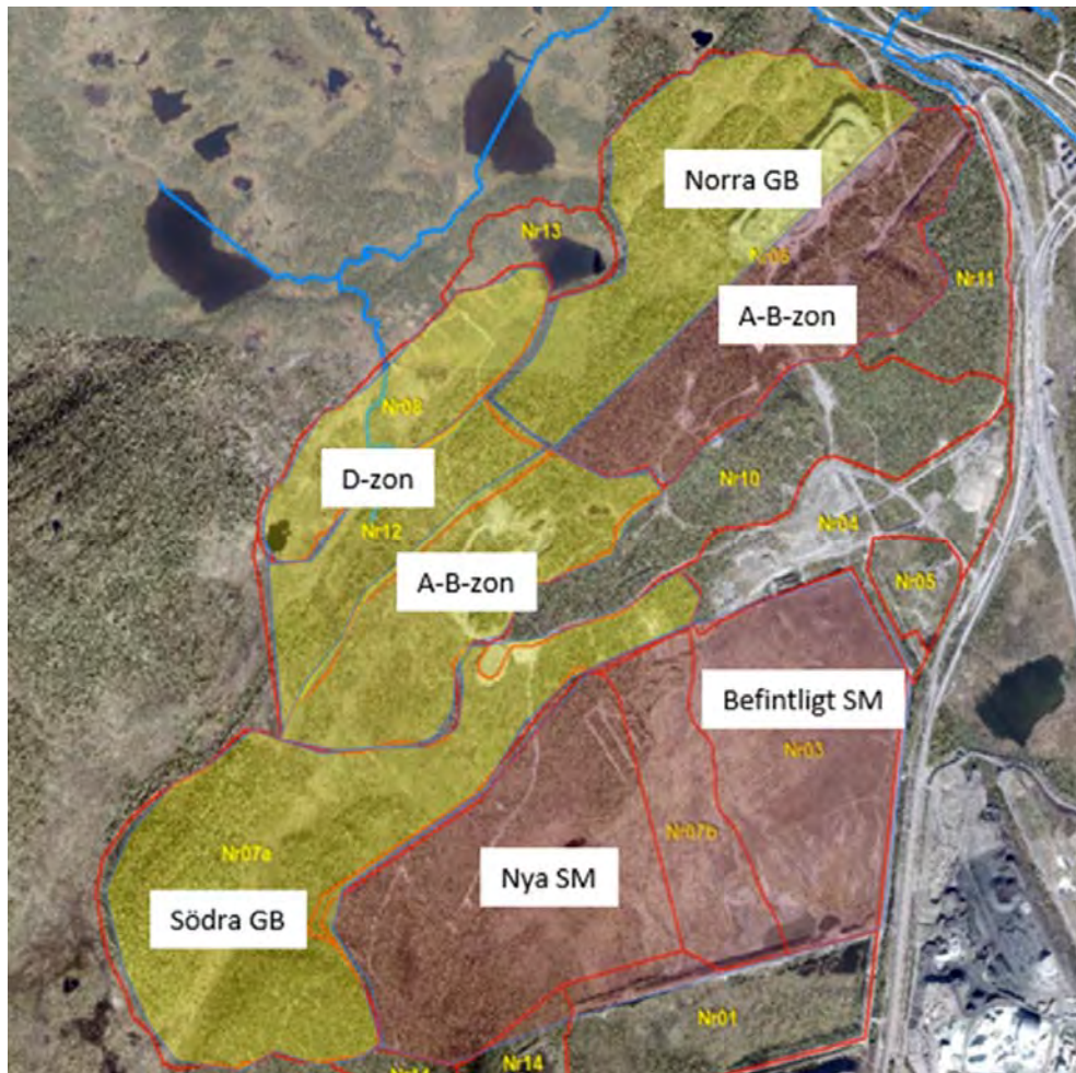
Figur 40 Grov uppdelning av delområden beroende på recipientväg. Röda delområden bedöms rinna via Luossajärvi/kanalen medan gula områden bedöms avrinna diffust norrut. GB=gråbergsupplag, SM=sandmagasin.
