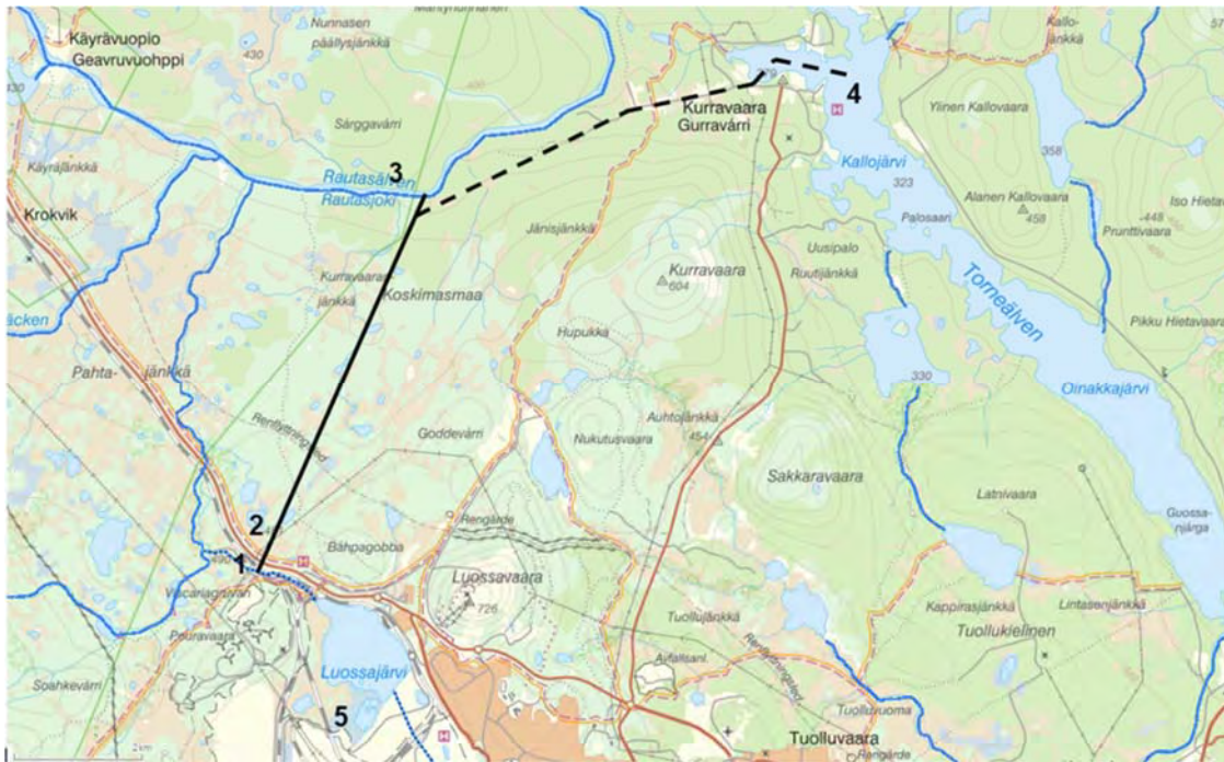
Figur 9. Alternativa utsläppspunkter för överskottsvatten. Ungefärlig dragning av erforderliga ledningsdragningar till Rautasälven och Torneälven visas med heldraget streck respektive streckad linje.
