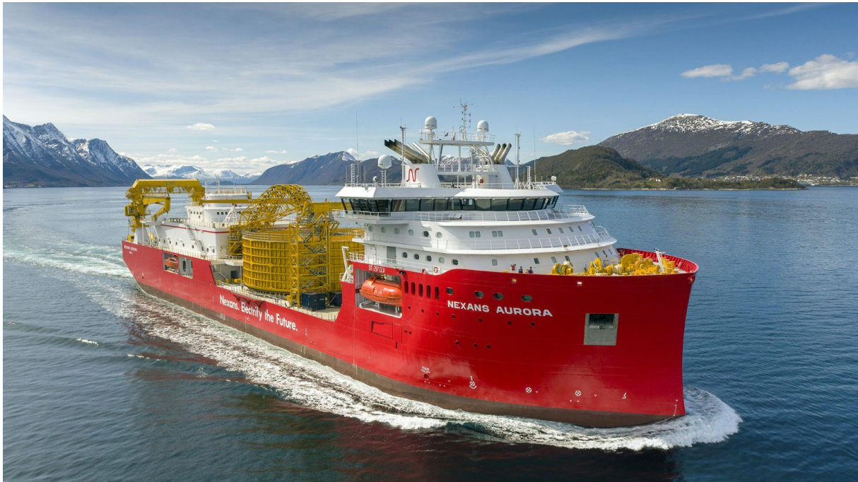
Kuva 3.9. Esimerkki kaapelinlaskuryityksestä, joka tekee monimutkaisia merenalaisia kaapelilinjoja (lähde: https://www.nexans.com/ )
