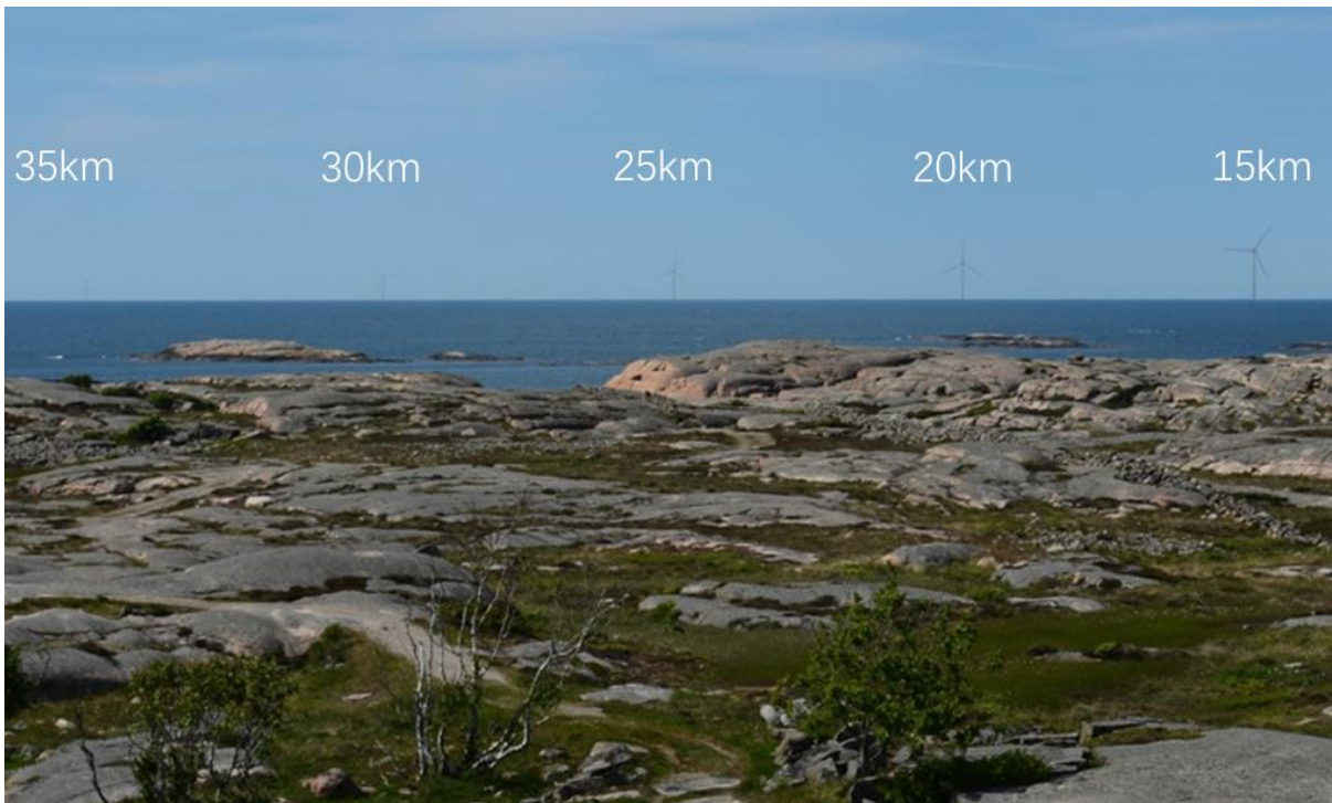
Kuva 40. Herkkyystutkimus tuulivoimalan visuaalisen vaikutuksen vaihtelusta näköetäisyyden mukaan. Analyysi perustuu 48 mm:n kameraoptiikkaan (vastaa ihmissilmää). Katsoja on 25 metriä merenpinnan yläpuolella, ja tuulivoimalat, joiden kokonaiskorkeus on 370 metriä, on sijoitettu 15–35 kilometrin päähän viiden kilometrin välein. Jotta kuva vastaisi paikan päällä havaittavaa mittakaavaa, sitä on tarkasteltava etäisyydeltä, joka vastaa neljä kertaa kuvan korkeutta.
