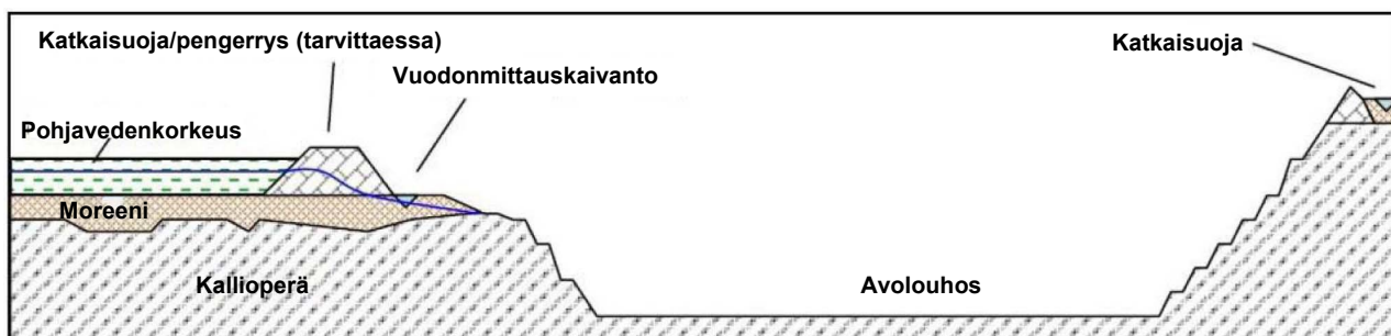
Kuva 8.8 Luonnos suunnitellun avolouhosalueen maaperän ja pintamaan poistometodeista. (Golder, 2021b).
