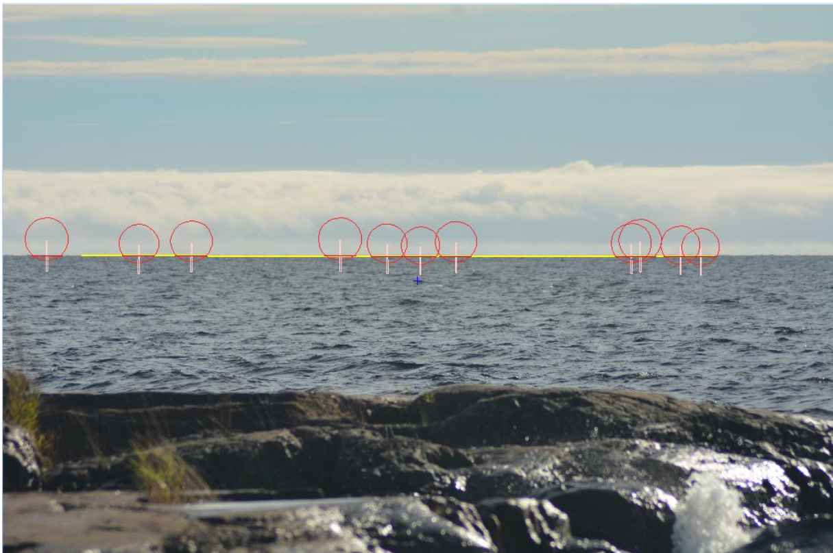
Figur 21 Edellä olevan kuvaesityksen näköyhteysanalyysi. Keltaisen horisonttiviivan alapuolella oleva osa jää piiloon horisontin taakse, ja punaiset viivat osoittavat turbiinien pintaa.
