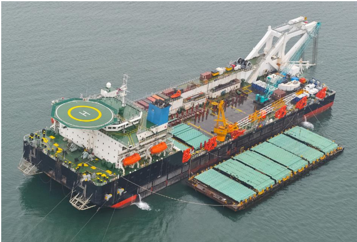
Kuva 8 - Esimerkki putkenlaskualuksesta (lähde: Mark J. Kaiser, 2020 ).
