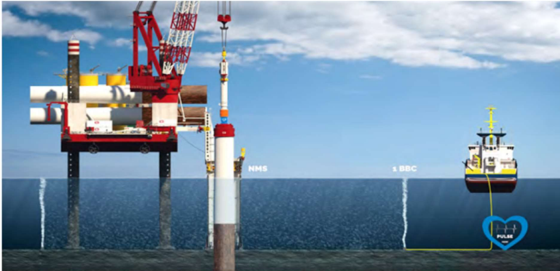
Figur 28 Exempel på pålningsinstallation. Källa IQIP
