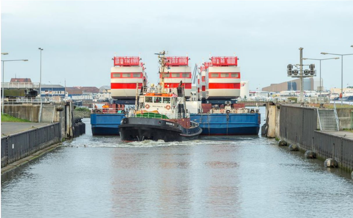
Kuva 24 Nacellien kuljetus pienemmillä aluksilla ©Skyborn Renewables
