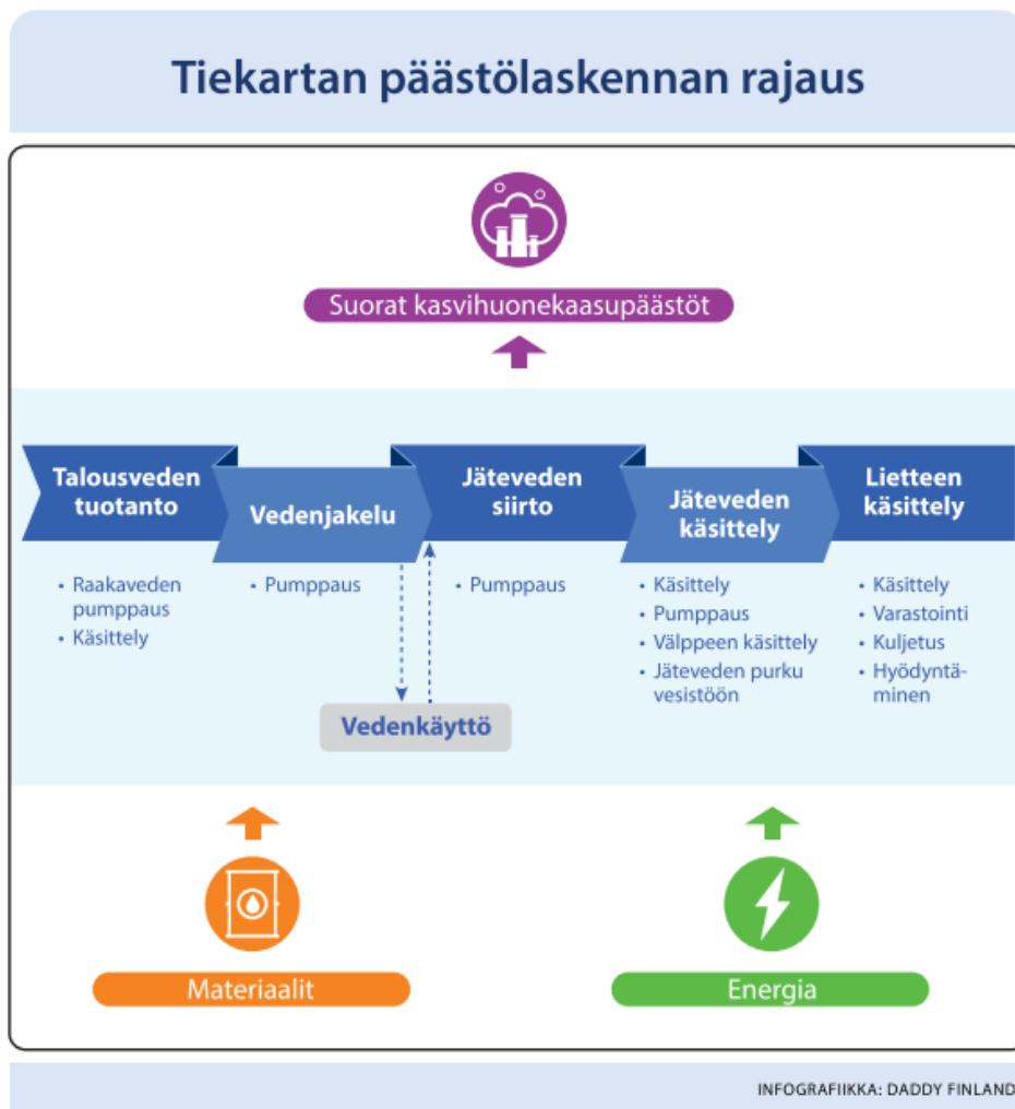
Kuvio 4. Kasvihuonekaasupäästöjä koskevan tarkastelun raja- us. Ener- gian osalta laskenta sisältää energiantuotannon päästöt ja mate- riaalien osalta raaka-aineiden ja polttoaineiden tuotannon ja kul- jetuksen päästöt. Tiekartta sisältää myös toimenpiteitä, joita ei tarkastella päästöjen laskennan yhteydessä (ks. luku 3).
