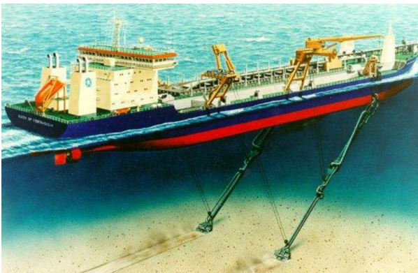
Kuva 13. Liikkuvalta alukselta imetään hiekkaa kahden imupään avulla laivan ruumaan. Suomessa hiekkamuodostumien pinnalla on tyypillisesti karkeampaa ainesta, joka voi tukkia imupäät, minkä takia liikkuvaa imuruoppausta ei aina voida suorittaa.
