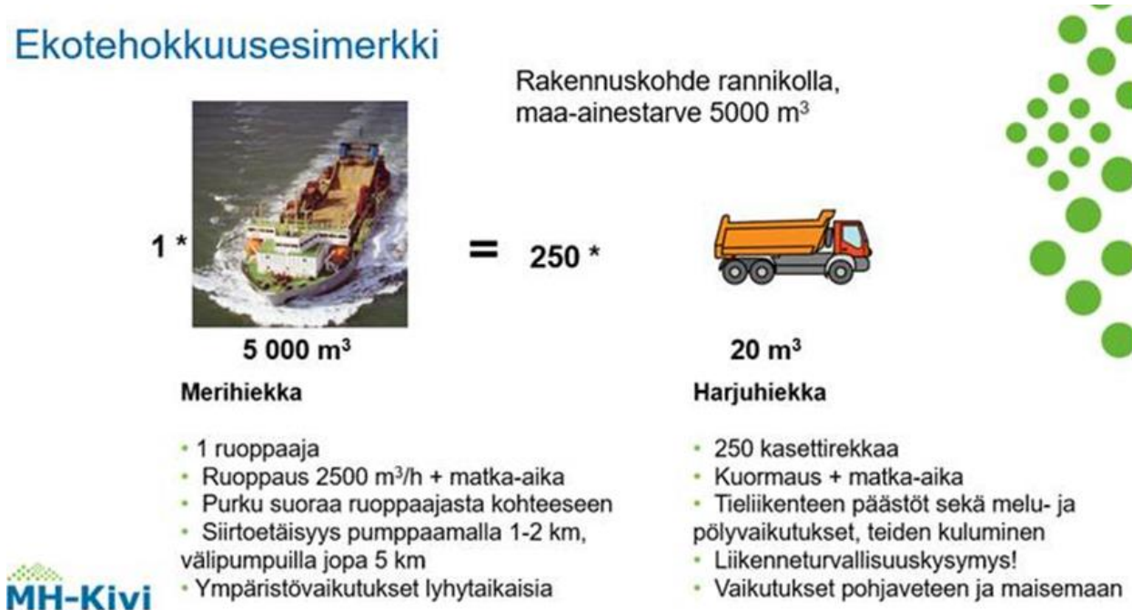
Kuva 8. Merihiekan ja harjuhiekan käytön ekotehokkuuteen vaikuttavat esimerkiksi käytetty teknologia, kuljetuskustannukset ja kuljetuksesta syntyvät päästöt, sekä ottotoimintaan kuluva aika.
