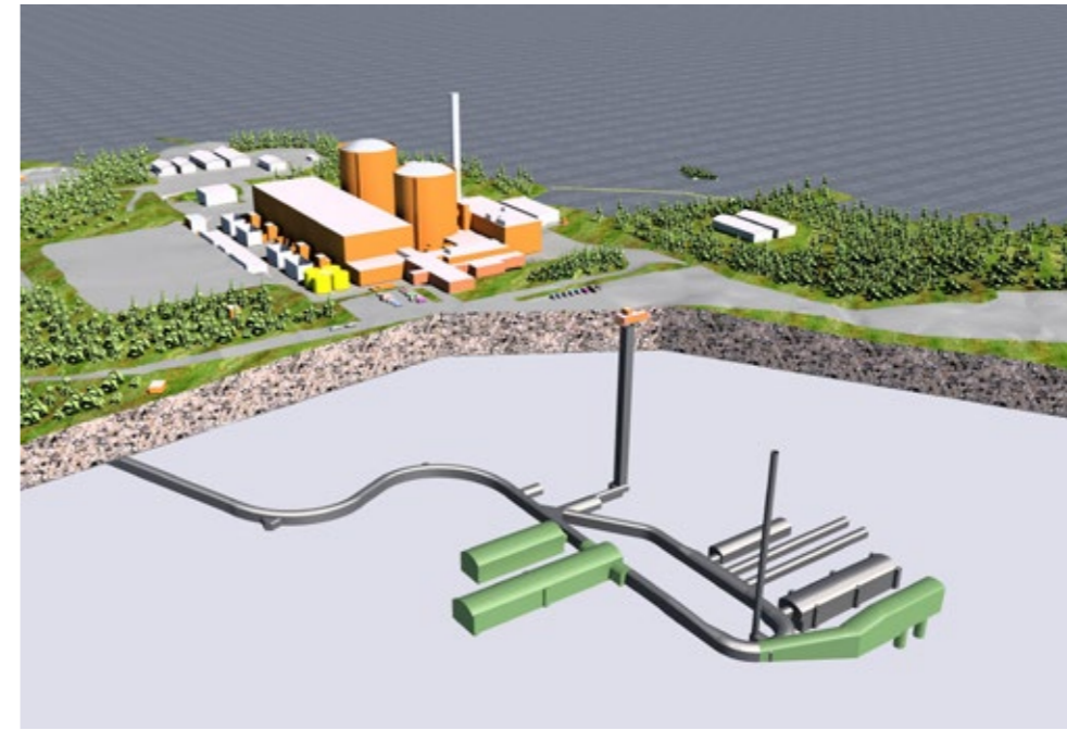
Kuva 3-7. Havainnekuva Loviisan voimalaitoksen matala- ja keskiaktiivisen jätteen loppusijoituslaitoksesta. Kuvassa on esitetty olemassa olevien tilojen lisäksi suunnitellut käytöstäpoistojätteen loppusijoitustilat (purkujätteen tilat 1 ja 2, suurten komponenttien tila ja paineastiasiiilot).
