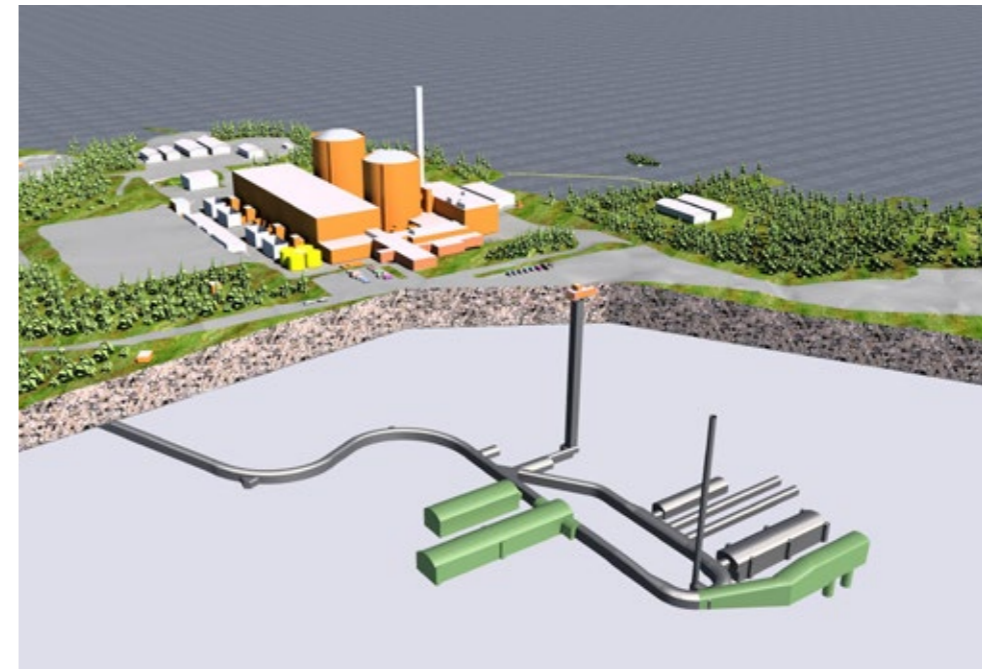
Bild 3-7. Illustration över slutförvarsanläggningen för låg- och medelaktivt avfall vid Lovisa kraftverk. Utöver befintliga hallar visas planerade slutförvarshallar för avvecklingsavfallet på bilden (hallar för rivningsavfall 1 och 2, hall för stora komponenter och silor för tryckkärl).
