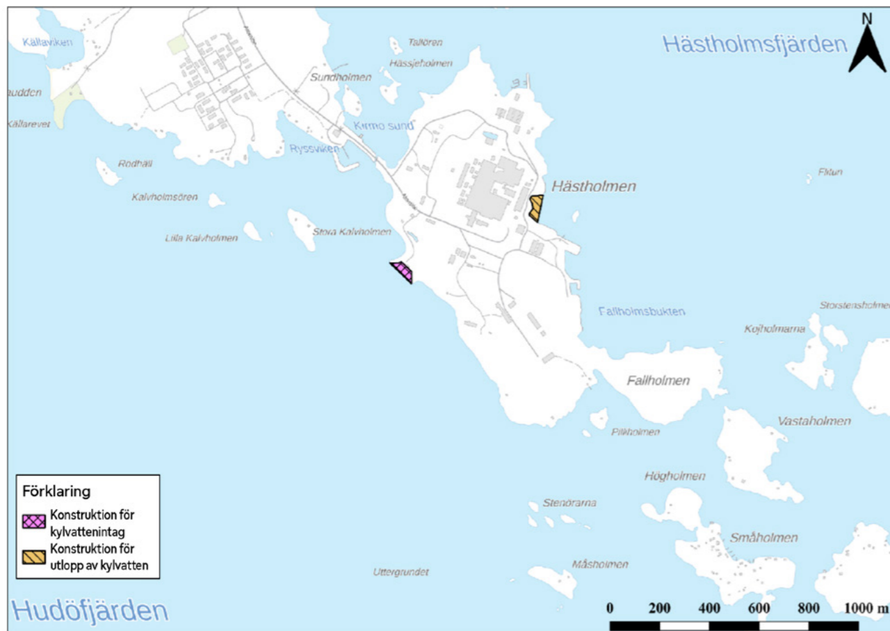
Bild 7-1. Läget för Lovisa kraftverks konstruktioner för kylvattenintag och -utlopp vid Hästholmen (kartbilden innehåller Lantmäteriverkets bakgrundskartmaterial 1:10000).
