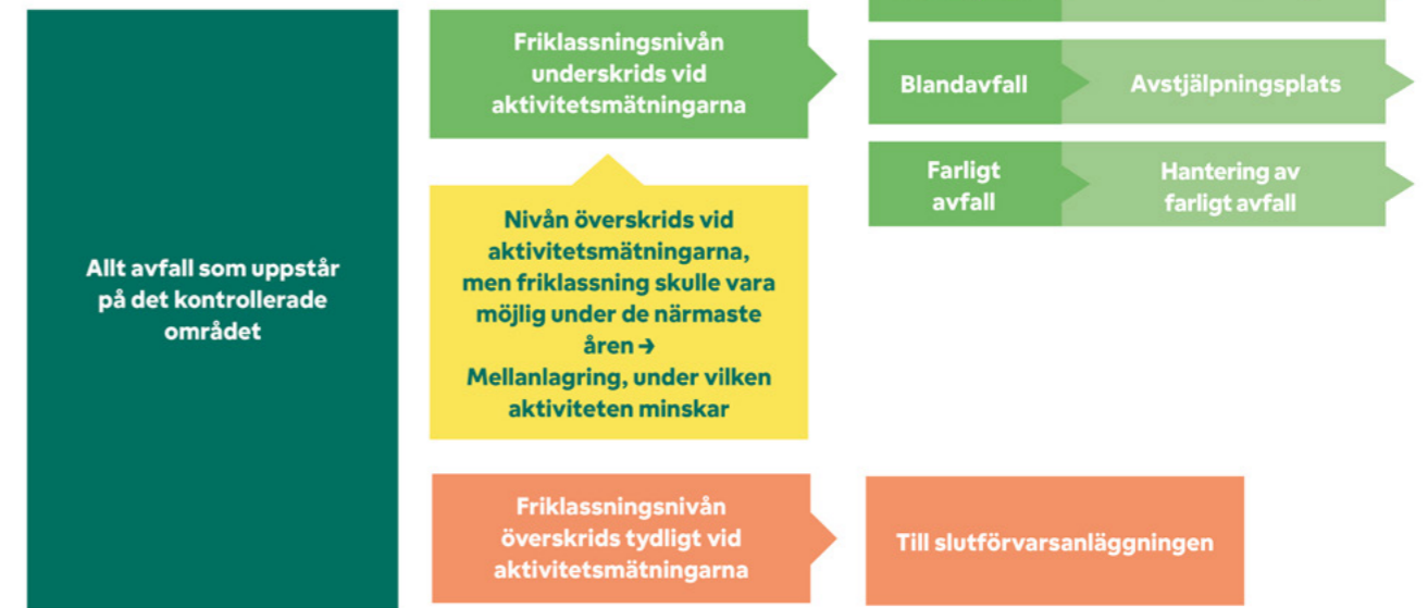
Bild 9-4. Allmänna principer för att behandla och slutförvara driftavfall som uppkommer på det kontrollerade området.
