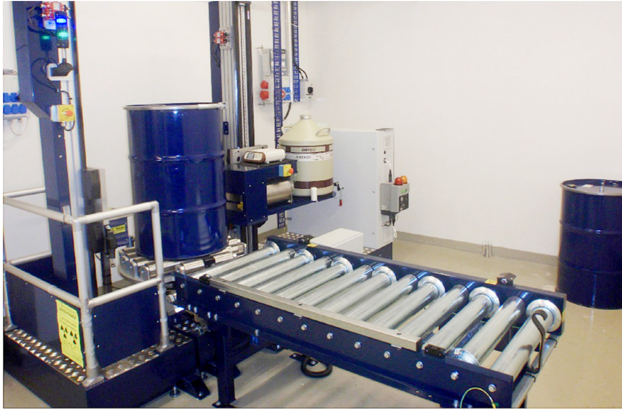
Bild 9-3. Gammalspektrometrisk utrustning, som används för att mäta radioaktiviteten i serviceavfallstunnor.
