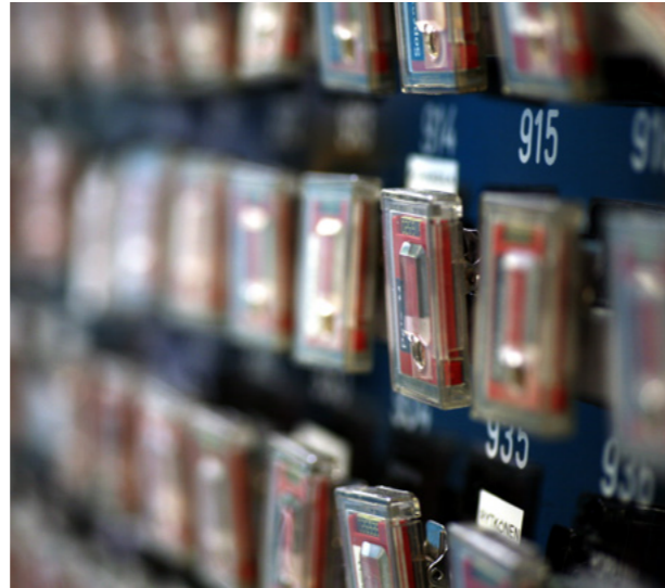
Bild 5-20. Stråldoserna hos personer som arbetar på det kontrollerade området kontrolleras med personliga termoluminescerande dosimetrar (TLD), som är officiella stråldosmätare.
