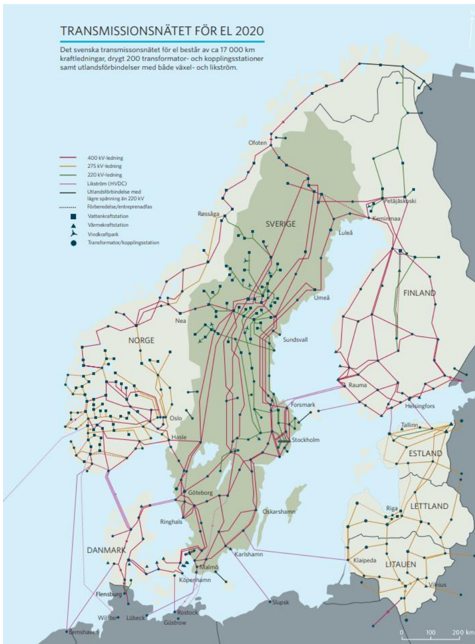
Kuva 35. Kuvassa on esitetty siirtoverkko vuonna 2020 (Ruotsin kantaverkko-yhtiö).
