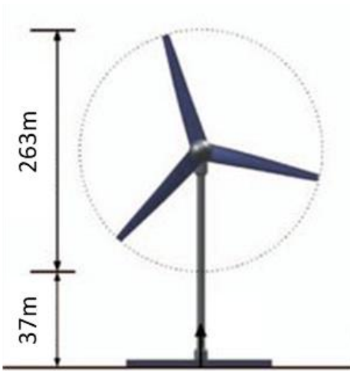
Kuva 4. Kuvassa esitetään tuulivoimaloiden koko alustavassa tuotantoanalyysissä. Kokonaiskorkeus on 300 metriä.
