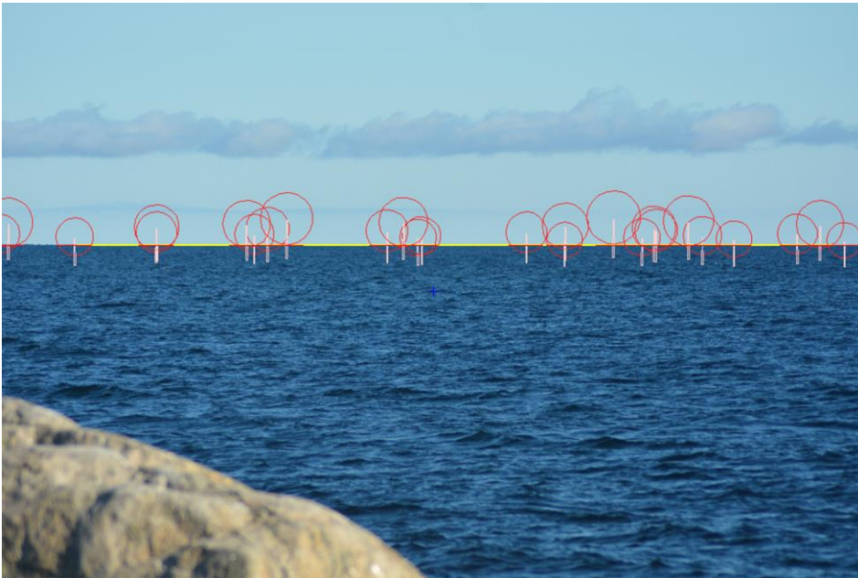
Figur 41. Visuell analys baserad på samma foto som nedre bilden i Figur 40. I denna analys representeras turbinerna av röda cirklar som ritats in framför havet fast de egentligen ligger skymda bakom horisontlinjen på grund av jordens krökning.
