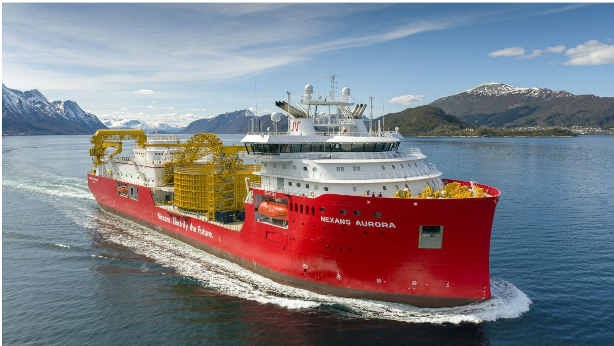
Figur 3.9. Ett exempel på ett kabellägningsfartyg som utför omfattande arbeten relaterat till utläggning av undervattenskabel (källa: https://www.nexans.com/ )
