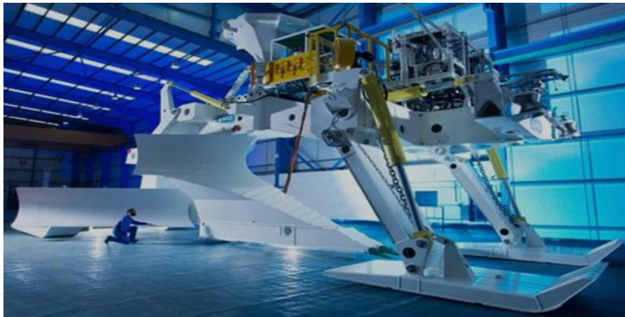
Figur 3.14. Ett exempel på kabelplog (källa: https://www.youtube.com/watch?v=wbll4zRA2M )
