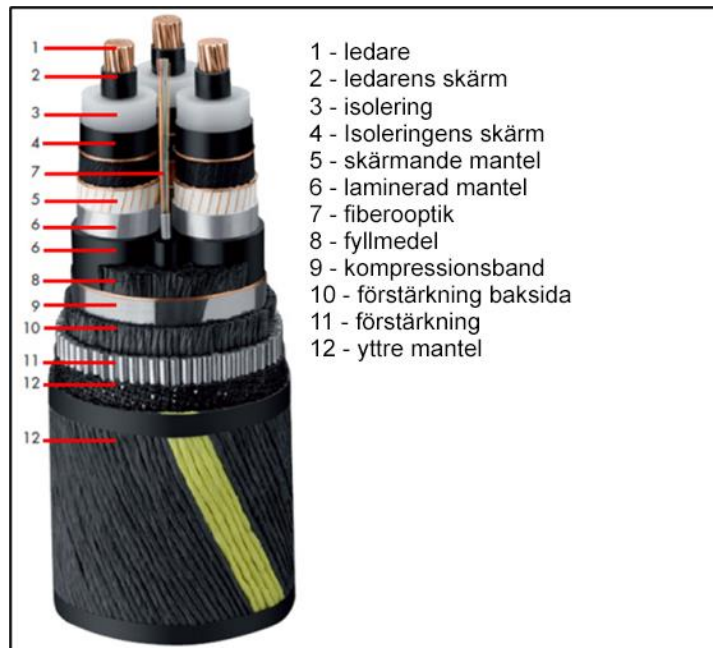
Figur 3.8. Konstruktion av en typisk trefas strömkabel med växelströmsteknik (källa: egen studie)
