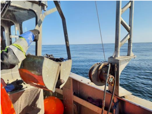
Kuva 31. esitetään pohjaeläimistön näytteenotto Van Veen -mallin näytteenottimella Vindpark Sylenissä.
