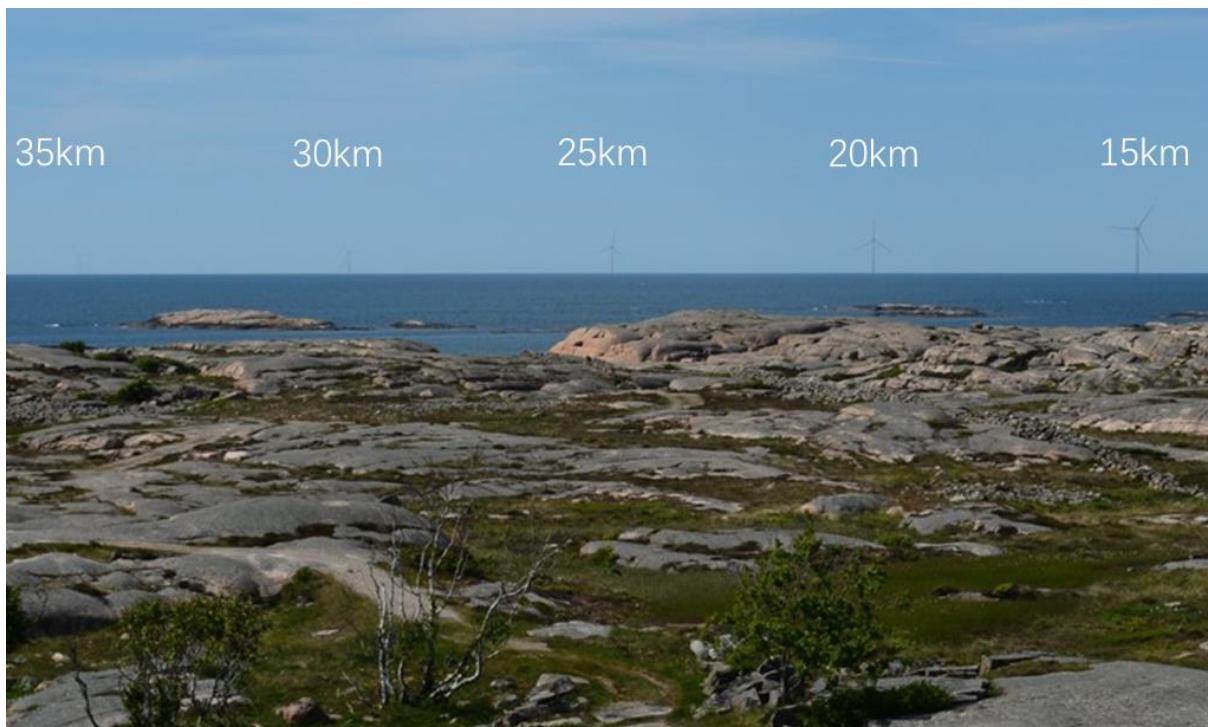
Figur 40. Känslighetsstudie av hur den visuella påverkan från ett vindkraftverk varierar med avstånd till land. Analysen är baserad på 48mm kameraoptik (motsvarar mänskliga ögat). Beträktaren står 25 m över havet och vindturbiner med en totalhöjd på 370 m har placerats på avstånd mellan 15 km och 35 km i steg om 5 km. För att motsvara upplevd skala på plats ska bilden betraktas från ett avstånd motsvarande fyra gånger bildens höjd.
