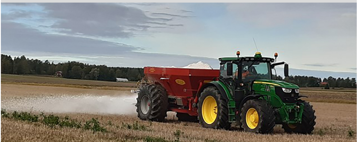
Kuva 8. Kipsinlevitystä (kuva: Varsinais-Suomen ELY-keskus)
