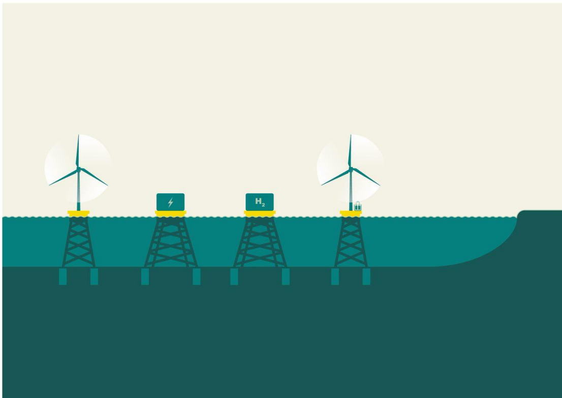
Figur 5. Principskiss över de olika delar som en energipark (centraliserad layout) generellt sett består av. Illustratör: Tobias Green.
