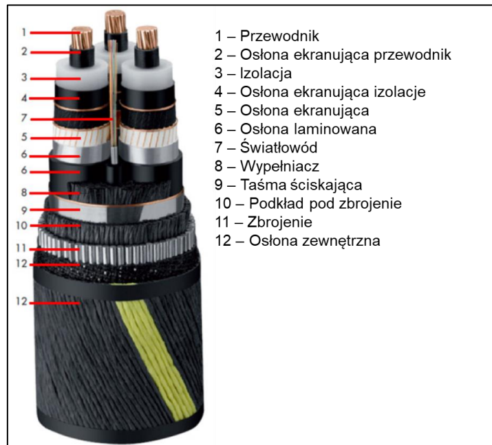
Kuva 3.8. Tyypillisen kolmivaiheisen vaihtovirtakaapelin rakenne (lähde: oma kehittäminen)
