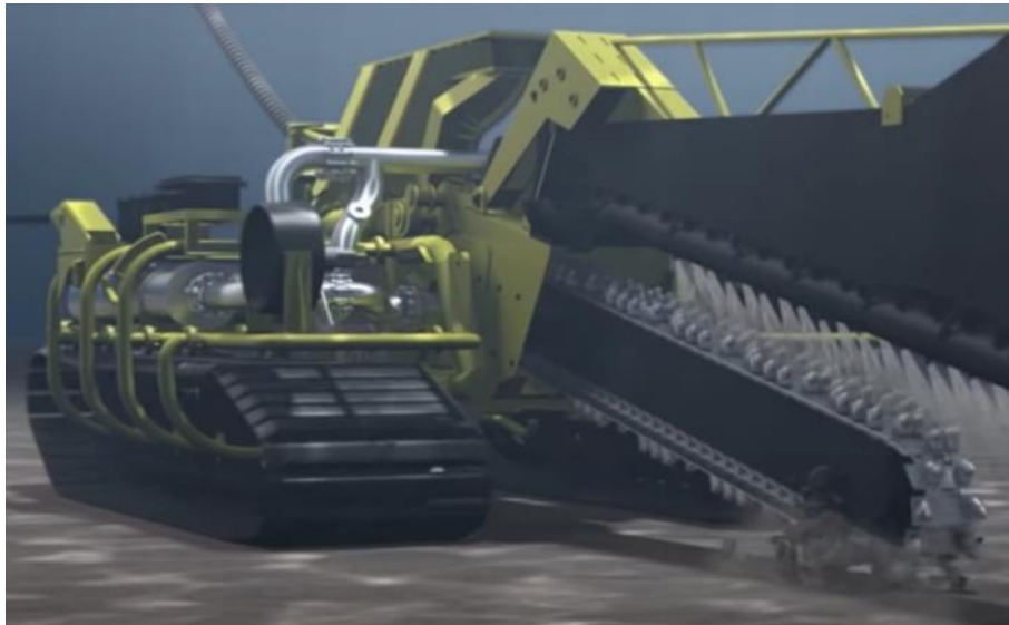
Kuva 3.12. Esimerkki mekaanisesta ruoppaajasta (lähde: www.boskalis.com )
