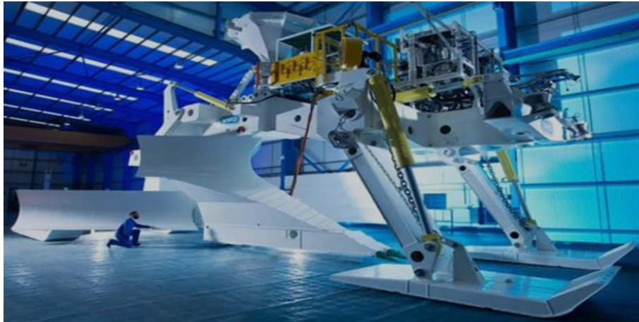
Kuva 3.14. Esimerkki kaapeliaurasta (lähde: https://www.youtube.com/watch?v=wbll4zRA2M )
