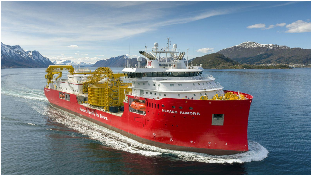
Kuva 3.9. Esimerkki kaapelinlaskuryityksestä, joka tekee monimutkaisia merenalaisia kaapelilinjoja (lähde: https://www.nexans.com/ )
