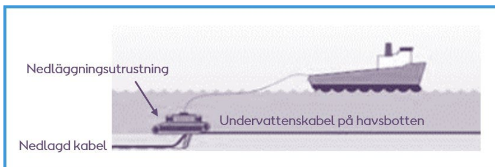
Figur 5-2 Exempel på hur nedgrävning av undervattenskablarna kan se om undervattenskabeln har lagts ut i ett tidigare skede (Illustration: Ramboll).
