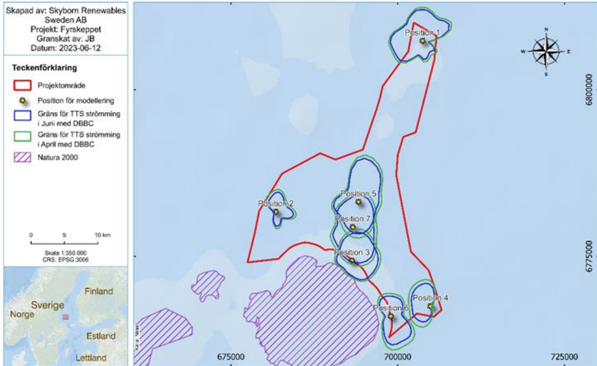
Kuva 7-8 Alueet mallinnettujen paalupaikkojen ympärillä, joissa silakkaan voi kohdistua TTS-vaikutuksia. Yhtiö on sitoutunut olemaan rakentamatta perustuksia kahden kilometrin säteellä Finngrundets Östra banken -nimisen Natura 2000 -alueen läheisyydessä sijaitse
